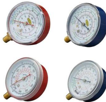
Gambar 14. Pengukuran tekanan terbaca nol pada tekanan atmosfer
