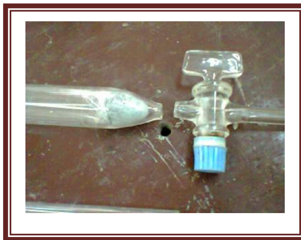
Gambar 5. Tabung Buret yang perlu diperbaiki dengan las kaca
