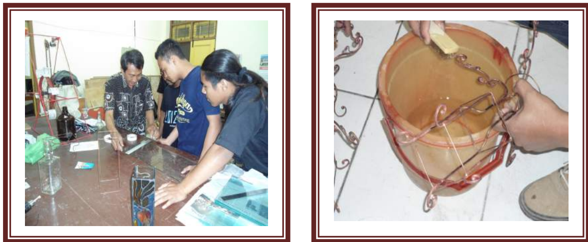
Gambar 4. Pemotongan kaca untuk digrafir dan pencucian kerangka tembaga hasil pengelasan
