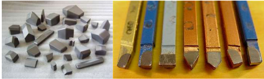
Gambar mata pahat sisipan dengan pemasangan pada tangkai dengan cara brazing (cumber: tungstek.cn)
