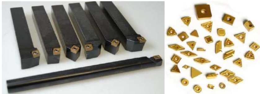
Gambar mata pahat sisipan dengan pemasangan pada tangkai dengan cara dibaut (sumber: chronos.ltd.uk)
