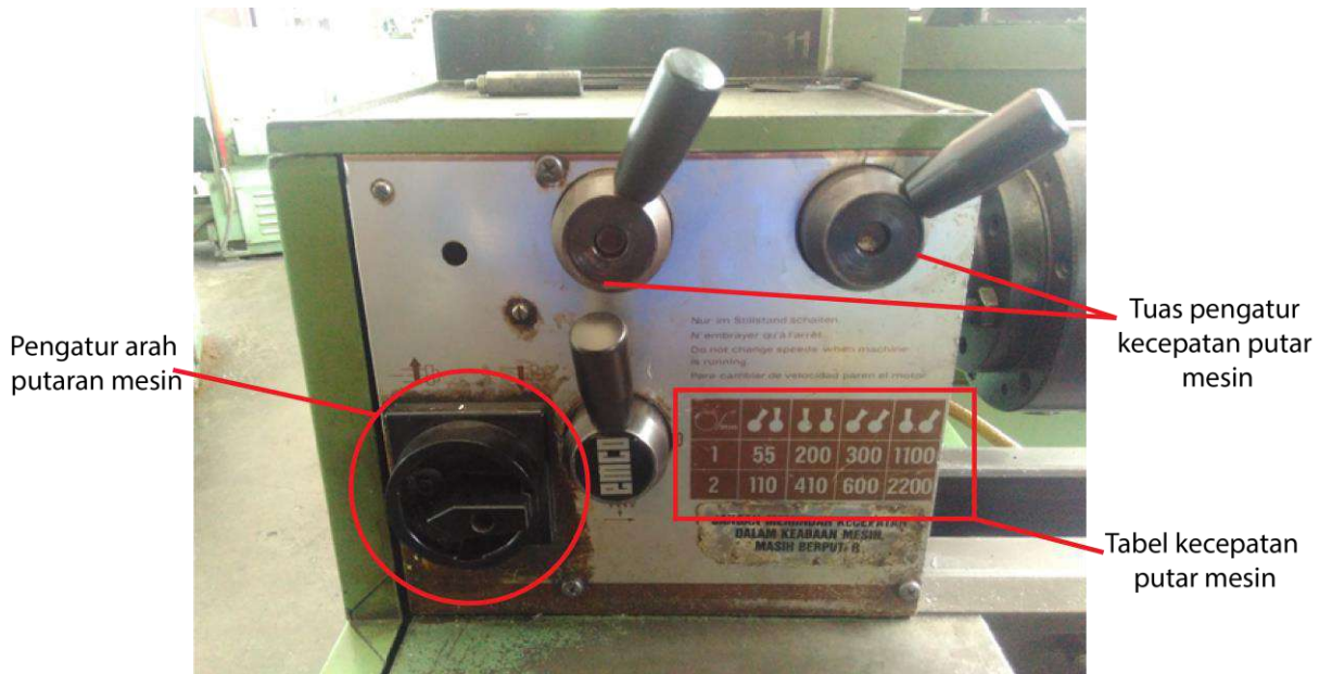
Gambar tuas pengatur kecepatan putar dan arah putaran mesin bubut
