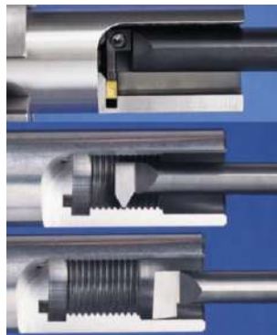
Gambar Contoh proses bubut dalam (sumber: thinbit.com)
