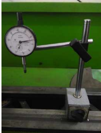
Gambar (a) Dial Indicator , (b) Setting posisi pemasangan benda dengan menggunakan dial indicator
