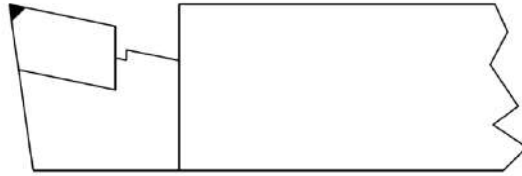
Gambar Pembentukan radius pada ujung pahat
