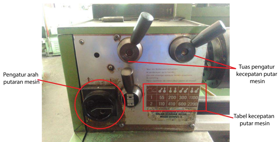
Gambar Mekanisme Pengatur Kecepatan Putar dan Arah Putaran Mesin Bubut
