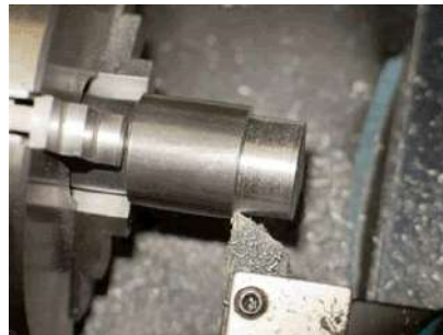
Gambar Proses bubut lurus (sumber: machinistblog.com)
