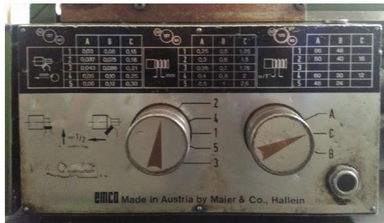
Gambar Pengatur kecepatan feeding pada mesin bubut beserta tabel kecepatan feeding yang tersedia
