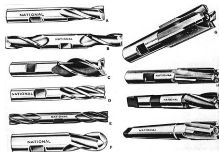
Gambar. 37. Pisau Jari ( End Mill Cutter ) (A) Dua mata satu ujung, (B) Dua mata dua ujung, (C) Tiga mata satu ujung, (D) Mata ganda satu ujung, (E) Empat mata dua ujung, (F) Dua mata ujung bulat,
