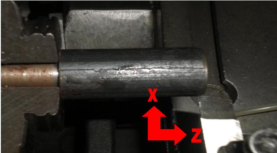
Untuk menggerakkan pahat pada mode manual ini bisa juga dilakukan dengan menggunakan *handwheel*. Untuk mengaktifkan *handwheel* dilakukan dengan cara menekan tombol mode JOG, kemudian tombol arah gerakannya. Tombol arah gerakan tersebut adalah :
