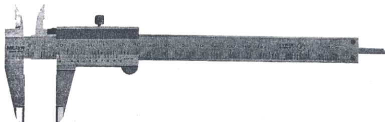
Gambar 19. Vernier Caliper ketelitian 0,05 mm
