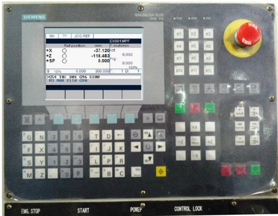
Gambar 1.10. Bagian Kontrol mesin CNC Sinumerik 802 S
