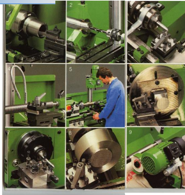
Gambar 2.17. Beberapa contoh proses bubut dengan cara pencekaman/pemegangan benda kerja yang berbeda-beda
