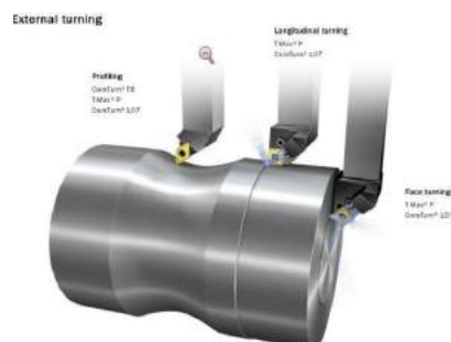
Gambar 3. Jenis proses pembubutan di mesin bubut CNC
