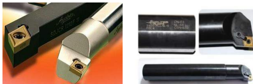
Gambar 6. Pahat sisipan yang dipasang pada pemegang pahat
