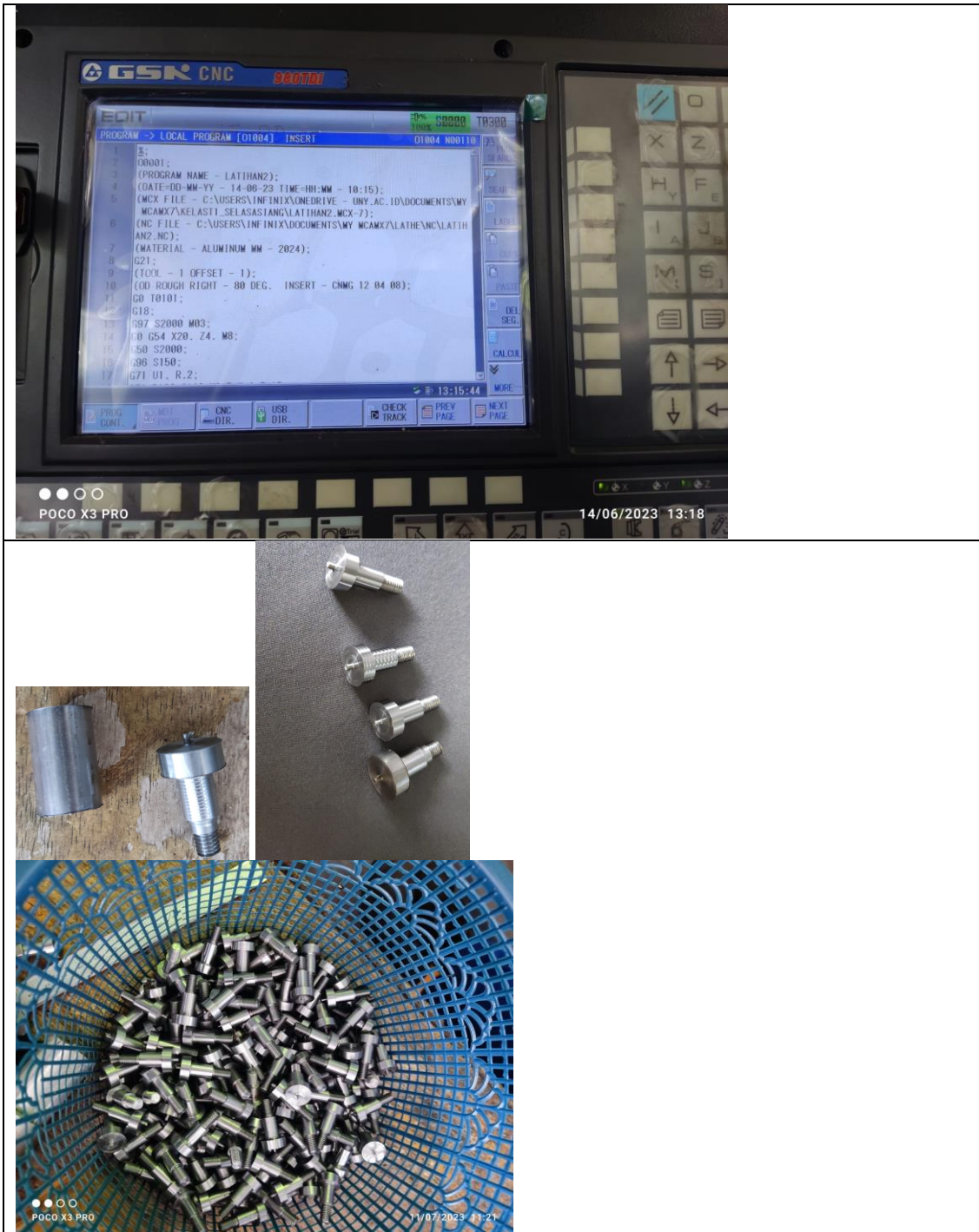
Gambar L4. Program CNC hasil CAM untuk membuat produk baut M6 dan produk yang dihasilkan
