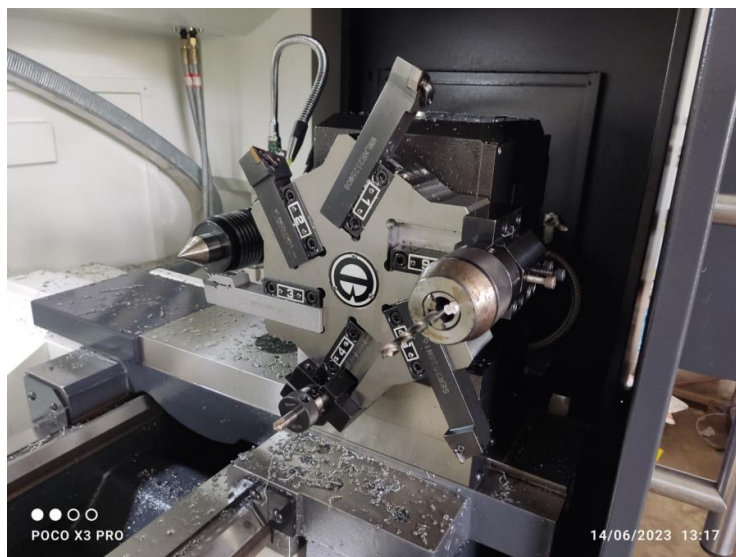
Gambar 13. Mesin bubut dan alat porong (cutting tools) bubut luar dan bubut dalam
