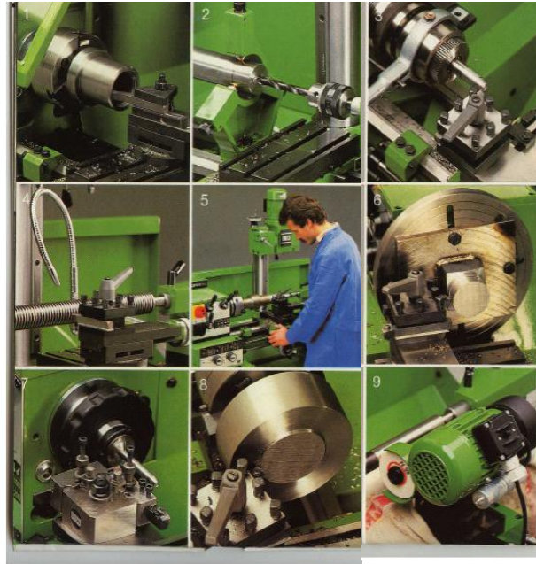
Gambar 2.17. Beberapa contoh proses bubut dengan cara pengecam-an/pemegangan benda kerja yang berbeda-beda
