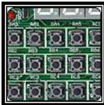
Keypad atau dalam ukuran yang lebih besar disebut keyboard merupakan salah satu jenis peripheral input manual disamping jenis lainnya seperti Mouse, Trackball, Joystick, Touch screen, dan Joypad. Dalam sistim berbasis mikrokontroler keypad sangat banyak digunakan. Mesin foto copy
