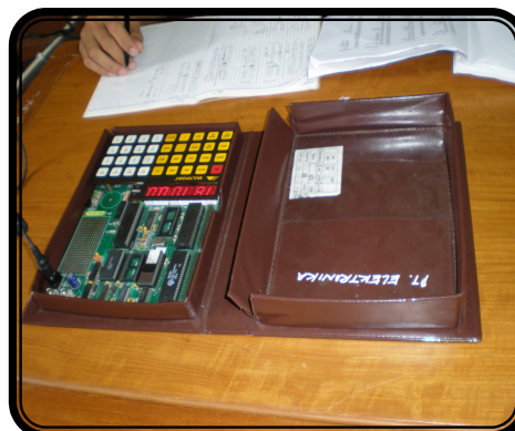
Gambar 7. Trainer Set Mikroprosesor MPF-1
