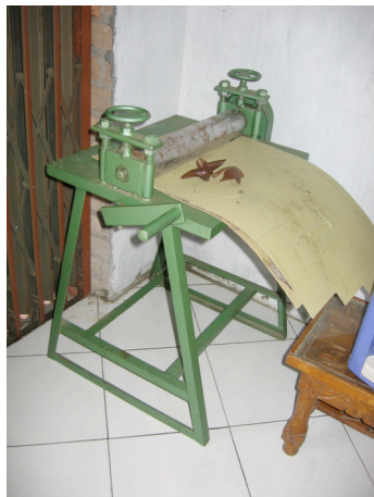
Mesin untuk meratakan kulit salak
