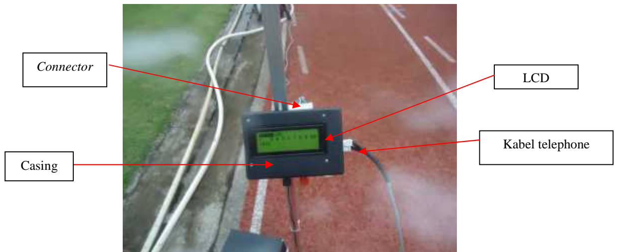
Gambar 9. Hasil Alat Pengukur kecepatan lari berbasis mikrokontroler yang dinyalakan awal dan finish
