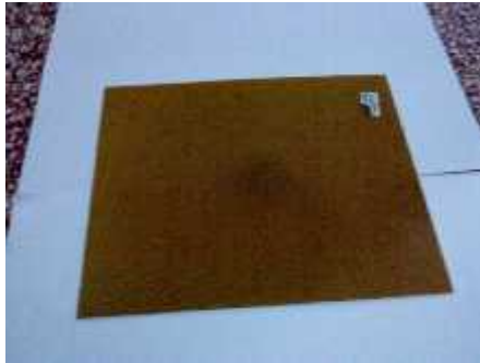
Gambar 2. PCB dengan jenis bahan pertinak
