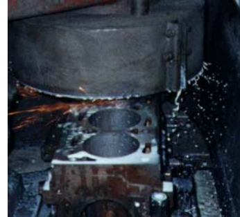
Gambar 10.5. Mesin Gerinda datar vertical-gerak meja bolak-balik.
