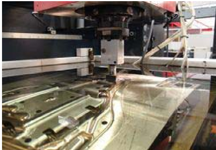
Gambar 14.1. Proses pengerjaan benda kerja dengan EDM (Dari : Wikipedia).
