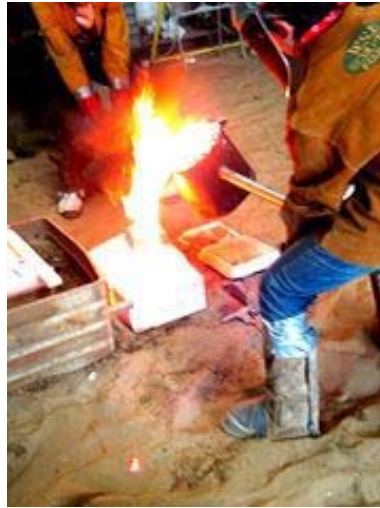
Gambar 2.1. Logam cair sedang dituangkan ke dalam cetakan
