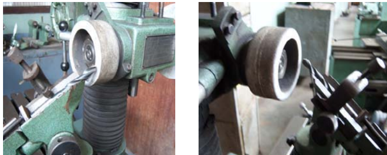
Gambar 8.15. Pengasahan mata bor dengan mesin asah.
