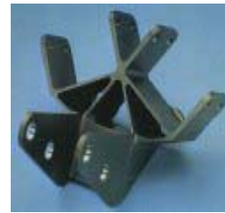
Gambar 14.11. Bagian mesin yang mengandung ukuran-ukuran kompleks dan dinding tipis. Komponen satelit ini dikerjakan menggunakan Wire Cut EDM dari bentuk solid CAL-4V Titanium, dikerjakan oleh Numerical Precision, Inc., Wheeling, Illinois.
