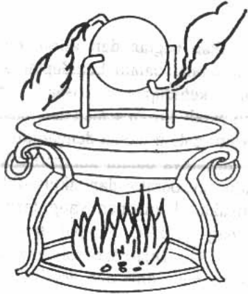
Gambar 2.19. Mesin konversi dari panas ke uap
