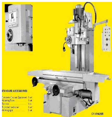
Gambar 7.8. Mesin Frais tipe bed .
