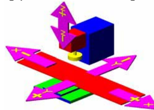
Gambar 12.85. Skema pergerakan koordinat Mesin CNC TU-3A.
