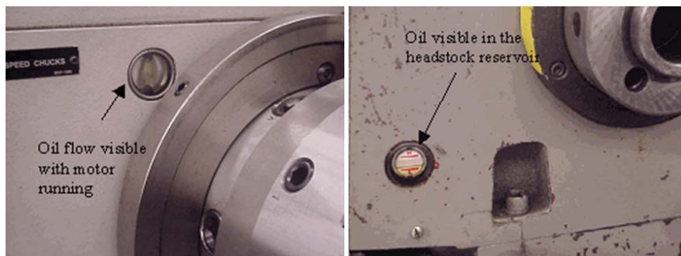
Gambar 1.6. Kaca kontrol reservoir di headstock
