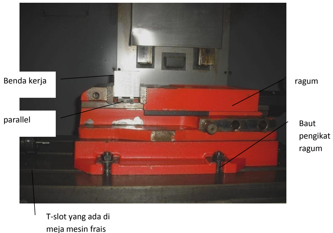
Gambar 3.1. Ragum yang terpasang di mesin frais
