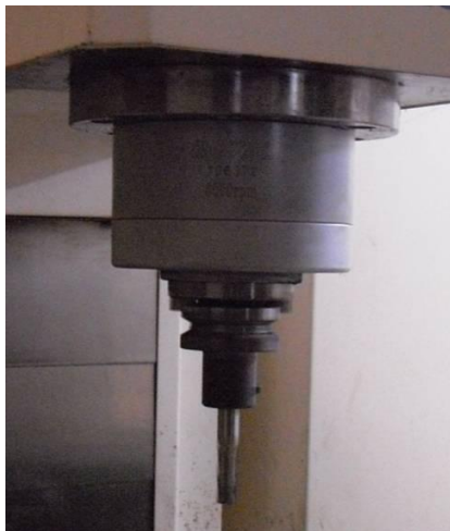
Gambar 3.14. End mill , kolet dan arbor dirangkai kemudian dipasang di spindle mesin frais CNC. Panjang dan diameter alat potong tidak sama maka harus dimasukkan data panjang masing-masing alat potong.
