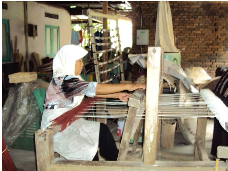
Gambar 3. Pembuatan Tirai dengan Alat Tenun Bukan Mesin
