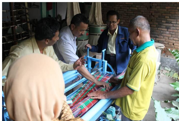
Gambar 11. Ujicoba Pemotongan Lebar Tirai dengan Mesin
