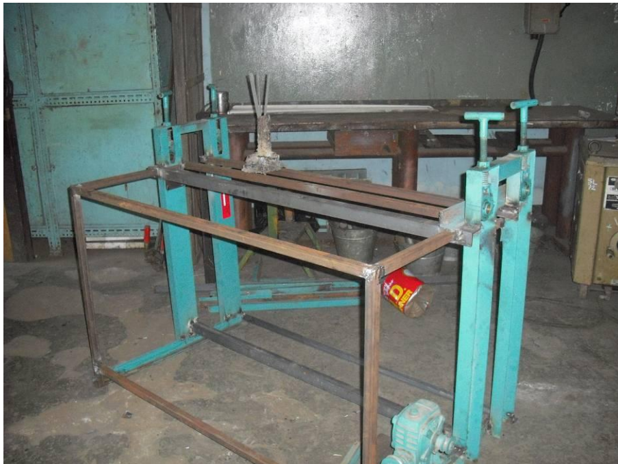
Gambar 7. Pembuatan bagian kerangka mesin pemotong
