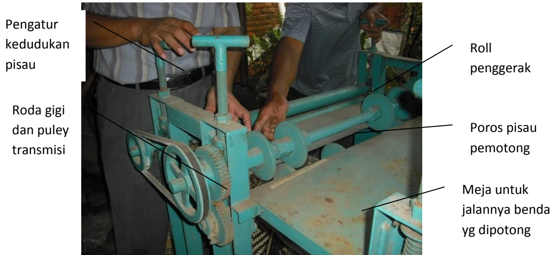
Gambar 5. Mesin pemotong yang lama yang akan direnovasi sedang diobservasi dan diukur.
