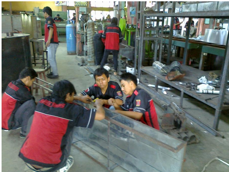
Gambar 12. Proses Pembuatan saluran udara panas oven kayu
