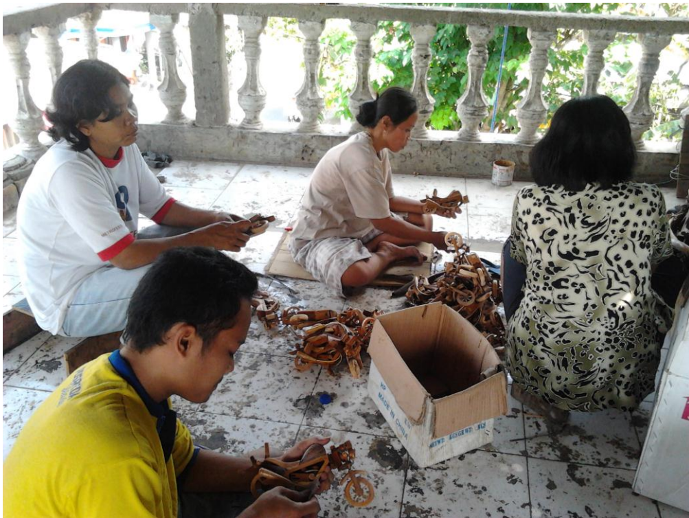
Gambar 8. Proses pengamplasan sesaat sebelum pengecatan ke-3 (finishing)
