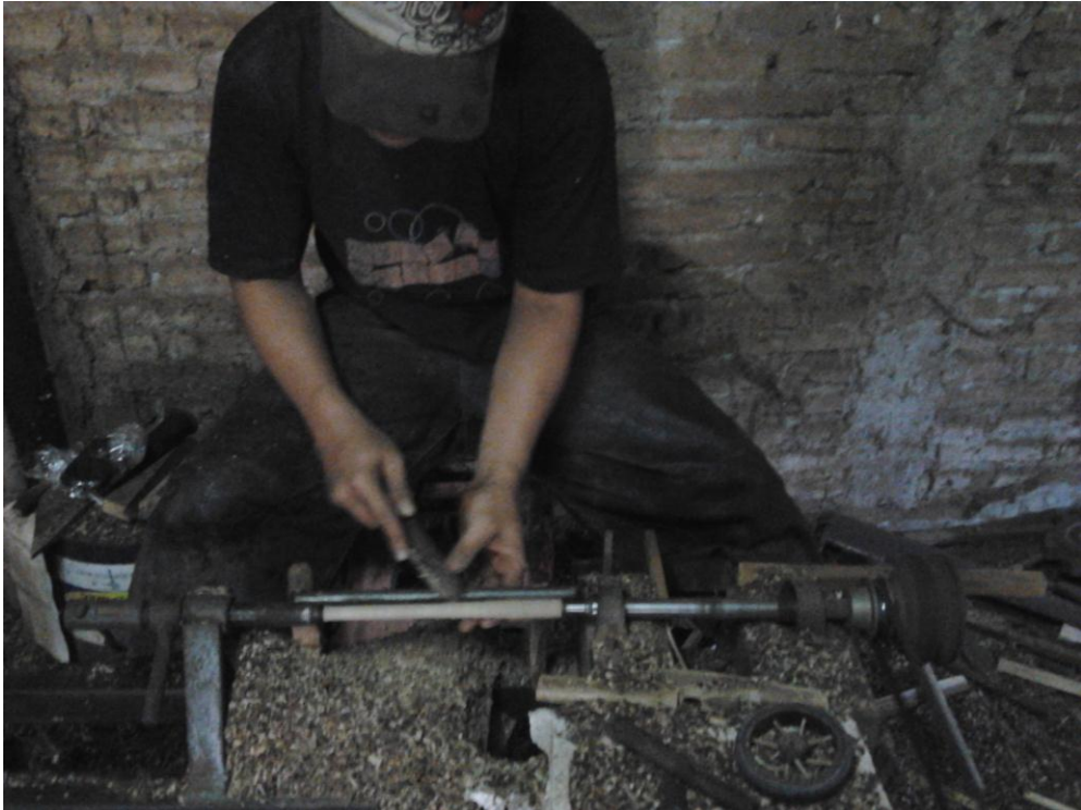
Gambar 5. Proses Pembubutan Kayu
