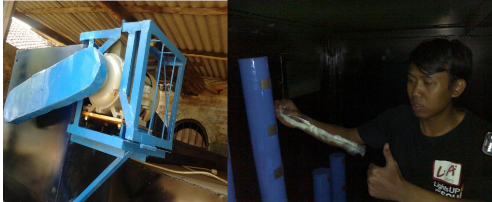
Gambar 15. Bagian kiri: Motor penggerak kipas penghisap udara panas Bagian kanan: Saluran udara panas dalam oven kayu
