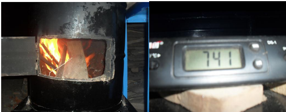
Gambar 16. Bagian Kiri: Api dalam tungku pada saat uji coba Bagian kanan: Suhu yang dapat dicapai pada ruang terjauh dari tungku
