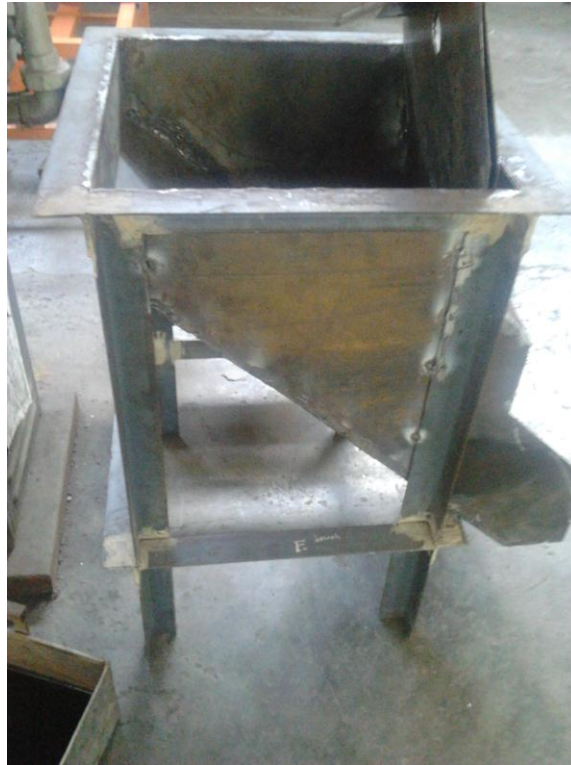
Gambar 21. Rangka untuk meja amplas baru sebagai pengganti mesin amplas lama]
