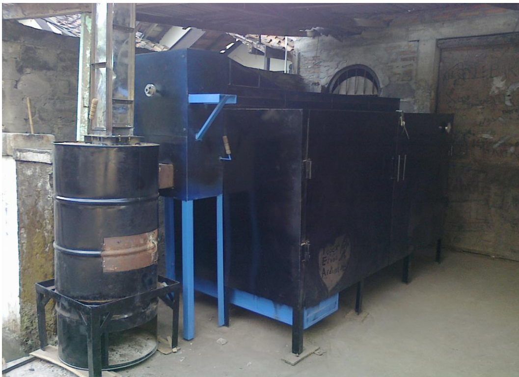
Gambar 14. Rangkaian Oven kayu sebelum motor kipas terpasang
