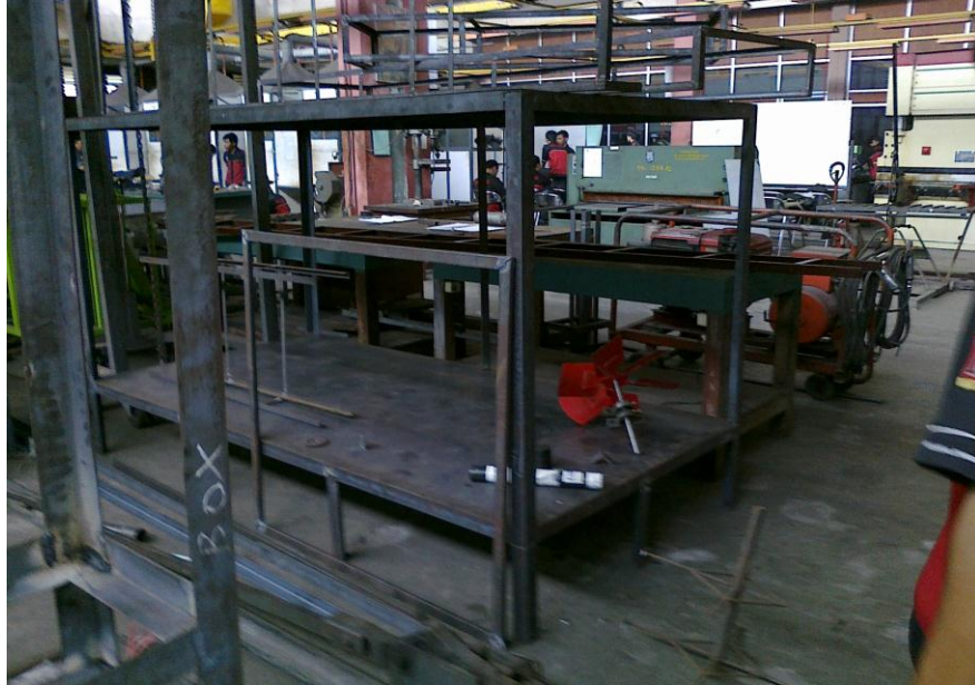
Gambar 11. Proses pembuatan rangka oven kayu di bengkel fabrikasi
