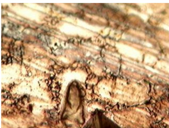
Gambar 6. Struktur mikro pada daerah tengah lasan (400X)
