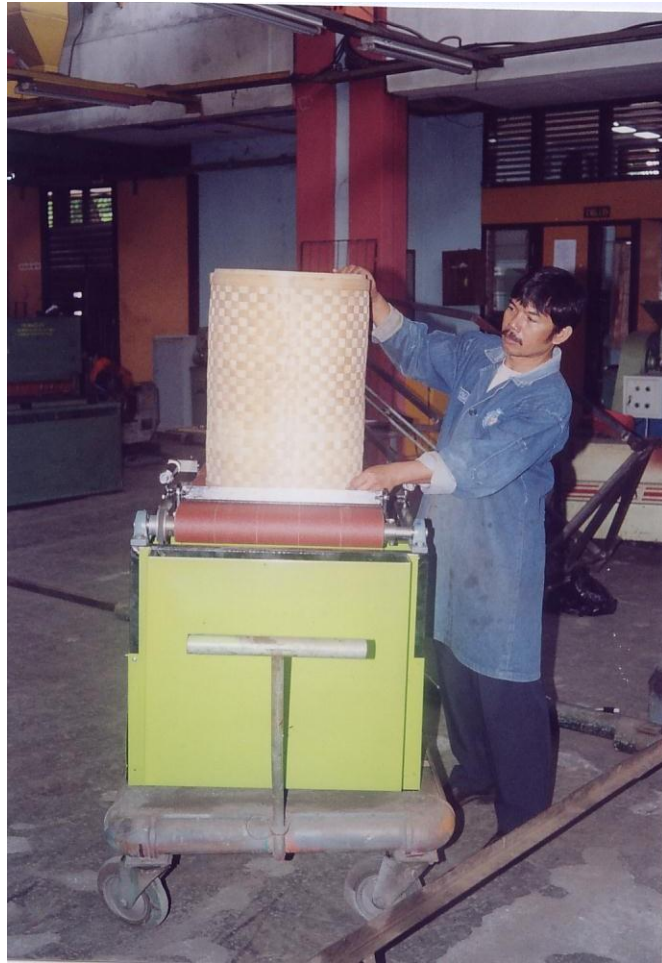
Gambar 8. Proses uji coba perataan produk yang lebar
