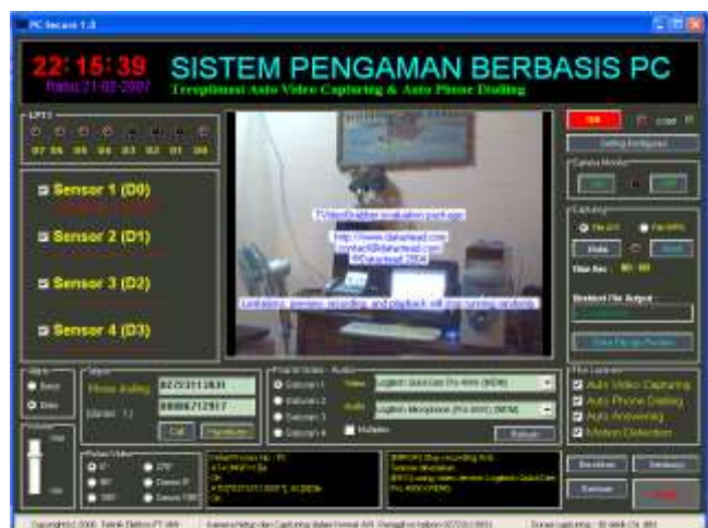
Gambar 4. Screenshot program ketika sensor 1 aktif. Tampak led D0 menyala, kamera hidup dan merekam kejadian, serta handphone sedang memanggil nomor 02723113931
