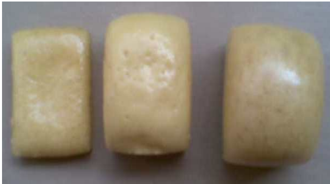
Gambar 6.1. Poliuretan dari Minyak Jarak-PEG 400-TDI (1:1:4)
