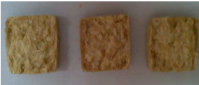
Gambar 6.17. Poliuretan dari Minyak Jarak:Ed:TDI (1:0,3:4)
