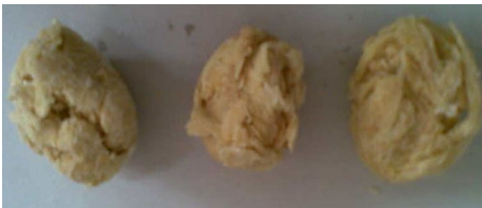
Gambar 6.18. Poliuretan dari Minyak Jarak:Ed:TDI (1:1:4)
