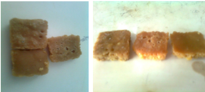
Gambar 6. 12. Poliuretan Hasil Sintesis dari Minyak Jarak:TDI:1,4-Butanadiol (1:4:1)
