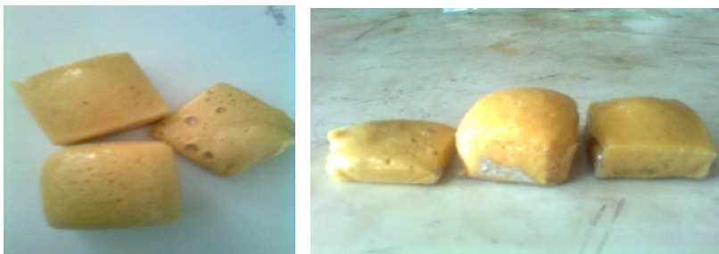
Gambar 6. 10. Poliuretan Hasil Sintesis dari Minyak Jarak: TDI: 1,4-Butanadiol (1:4:1)
