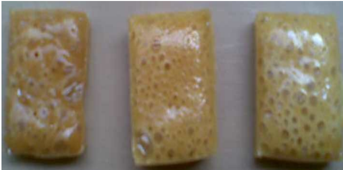
Gambar 6.3. Poliuretan dari Minyak Jarak-PEG 400-TDI (1:3:4)
