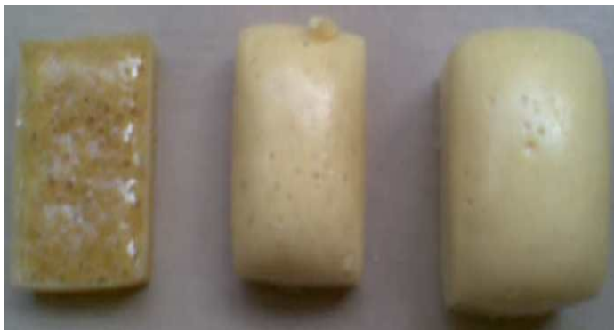
Gambar 6.1. Poliuretan dari Minyak Jarak-PEG 400-TDI (1:1:4)
