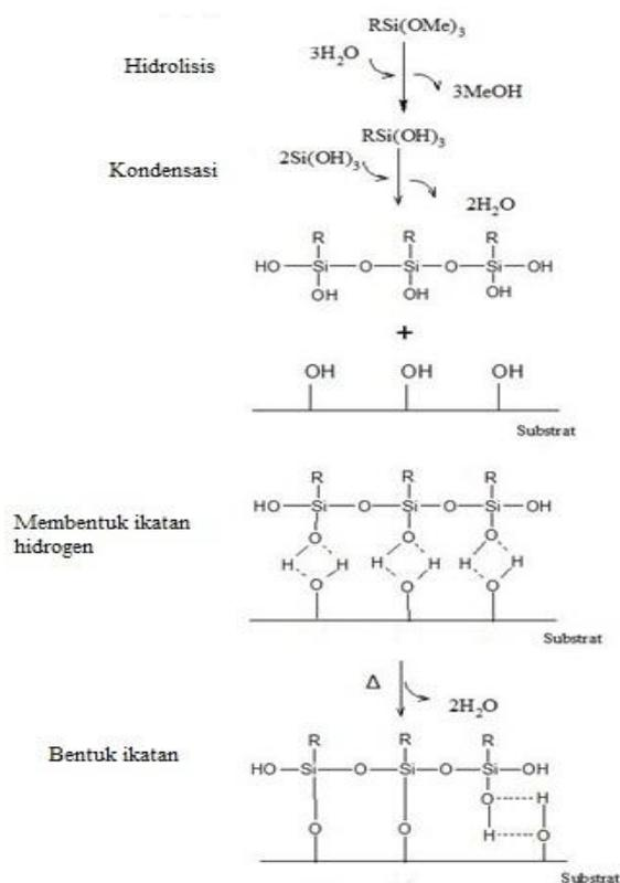
Gambar 2. Reaksi Pelapisan Senyawa Silan pada Serat Poliester
