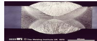
Hasil uji struktur makro pada sambungan las
