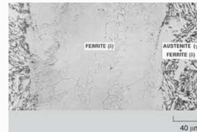
Hasil uji struktur mikro pada sambungan las
