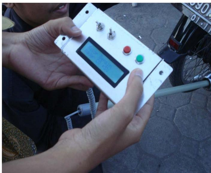
Gambar Display Hasil Pengujian Alat untuk Uji Emisi
