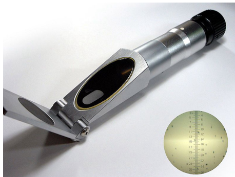
Gambar 2. Refraktometer tangan tradisional. Refraktometer digunakan untuk mengukur indeks refraksi. Untuk larutan gula, indeks refraksi dapat digunakan untuk menentukan kadar gula (Wikipedia, 2009).
