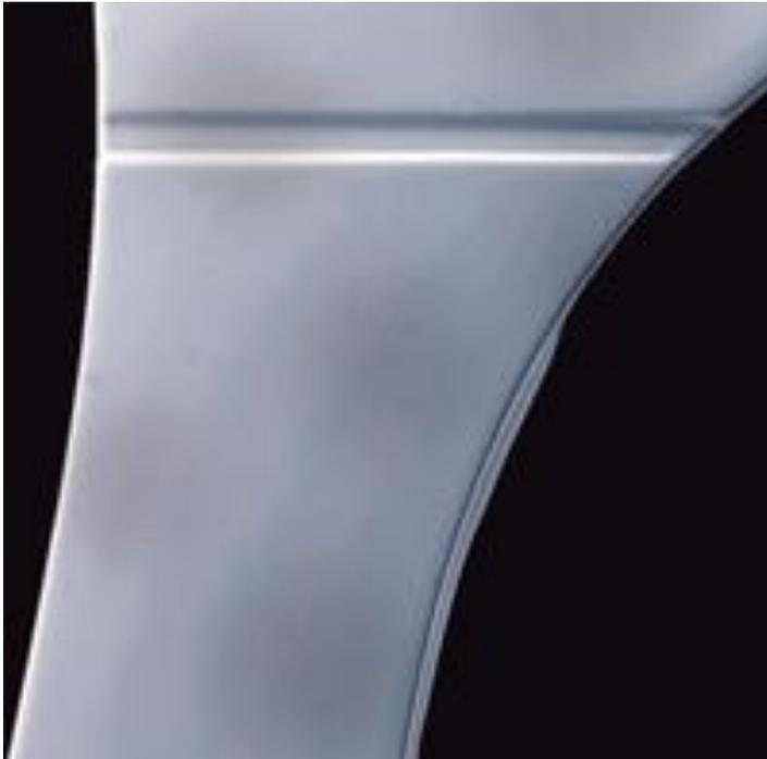
Cacat yang sering terjadi pada cat jenis metalik, dimana serpihan metal mengapung sehingga membentuk garis atau mirip dengan jerawat. Cacat jenis ini dikenal juga dengan istilah *striping, banding, shadowing, flooding, floating, misting, precipitation, blooming, bloom* atau *bleaching*.
