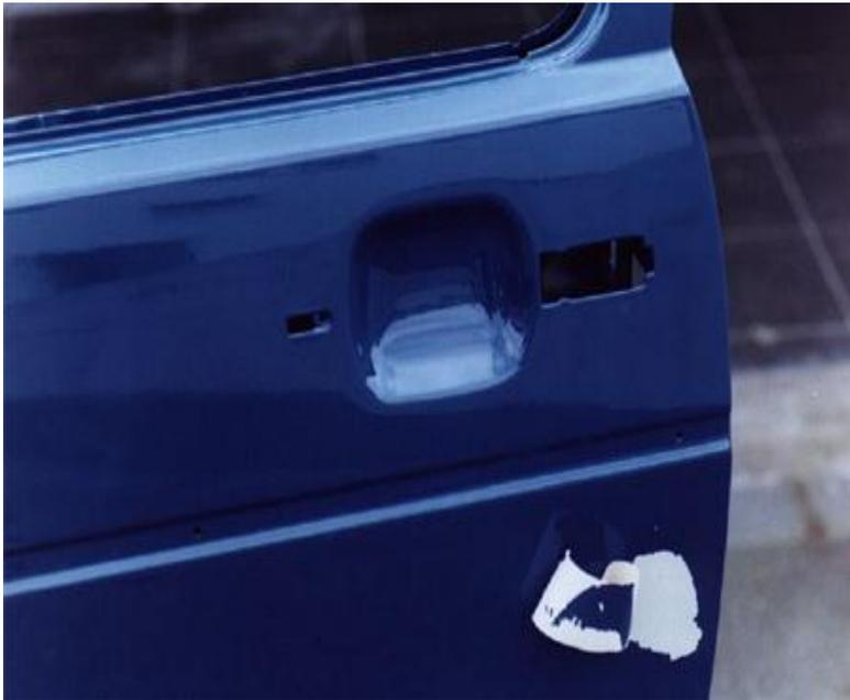
Merupakan kerusakan cat yang disebabkan oleh hilangnya daya rekat antara cat dengan substrat, topcoat dengan primer atau cat lama serta primer dengan substrat. Nama lain dari kerusakan ini adalah *loss of adhesion*, *shelling*, *poor bond*, *delamination*, *flaking*, atau *poor adhesion*.
