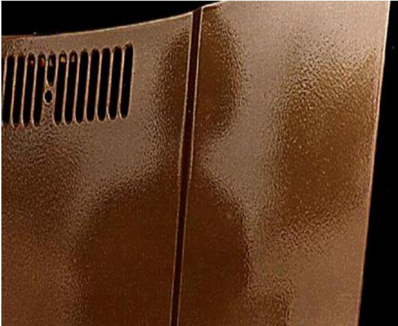
Merupakan cacat pengecatan dengan bentuk permukaan yang tidak merata, seperti kulit jeruk yang disebabkan oleh kasarnya butiran yang kurang teratomisasi dengan baik. Butiran cat yang kering sebelum lapisan merata (tidak kering bersama). Cacat ini juga dikenal dengan nama *poor flow*, *poor levelling*, *pebbling*.
