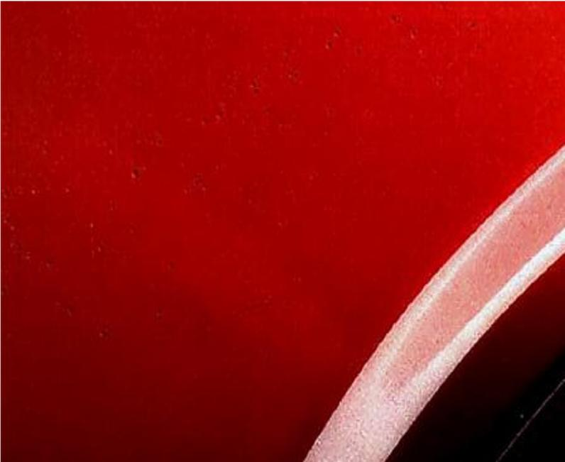
Merupakan cacat pengecatan berupa lubang saat penyelesaian akhir, atau lubang pada dempul, atau primer yang disebabkan oleh pengencer, udara, kelembaban atau persiapan permukaan yang tidak baik. Istilah *pinholing* juga dikenal sebagai: *pin holes*, *solvent retents*, *pock marks*, *pitting*, *pops*, ataupun *pin pricks*.
