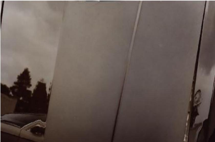
Merupakan cacat berupa menghilangnya kilap setelah lapisan cat mengering, dikenal juga dengan istilah *loss of gloss*, atau *dieback*.
