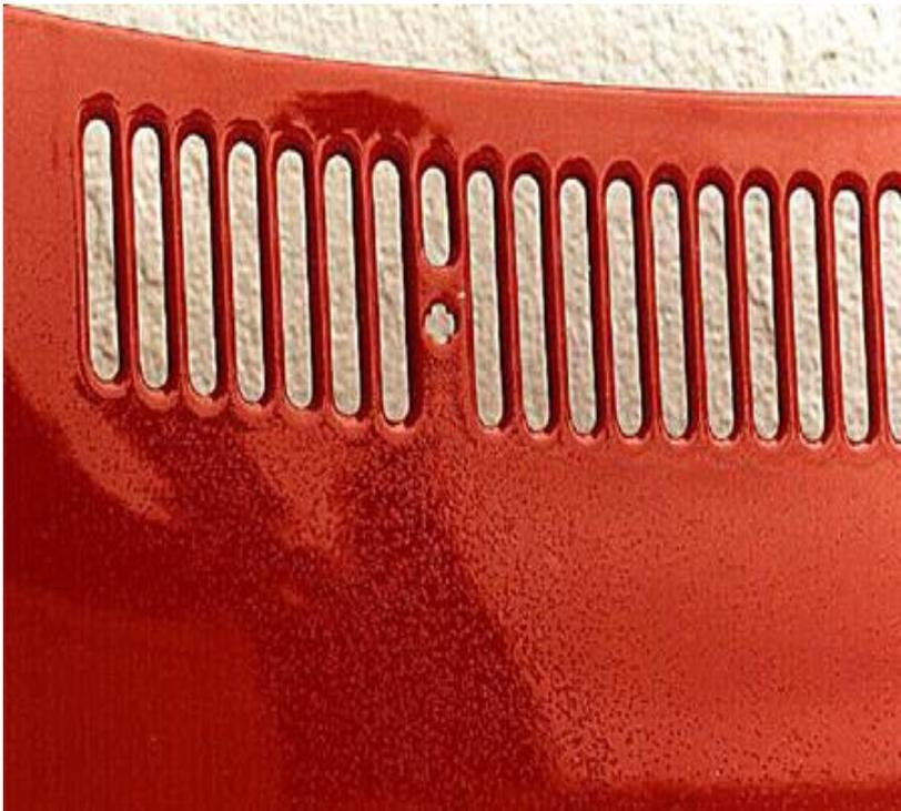
Merupakan cacat berupa luka atau lecetnya lapisan cat yang disebabkan oleh pengencer yang terjebak dalam lapisan atas atau lapisan bawah, terlebih lagi apabila dipengaruhi oleh pengeringan yang tidak tepat. Cacat jenis ini juga dikenal sebagai boiling, solvent boil, boil, atau popping.
