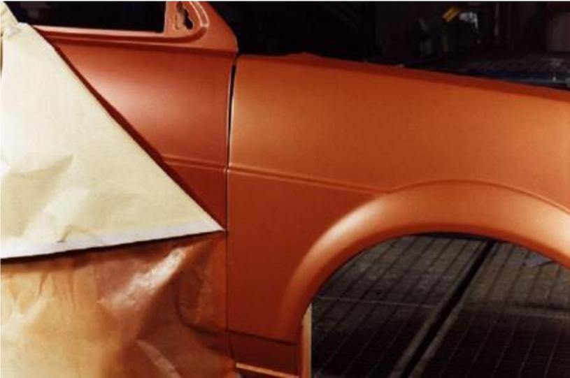
Warna bagian bodi yang diperbaiki berbeda dengan warna asli bagian bodi lainnya, sering disebut juga dengan . *wrong color, off shade, mismatch fading* atau *off color*.
