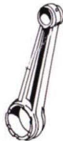
Gambar 2.13. connecting rod dibuat dengan proses penempaan panas.
