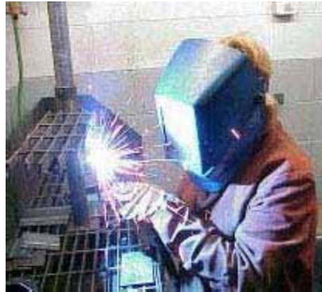
Gambar 1. Pekerjaan Mengelas menggunakan las busur nyala listrik
