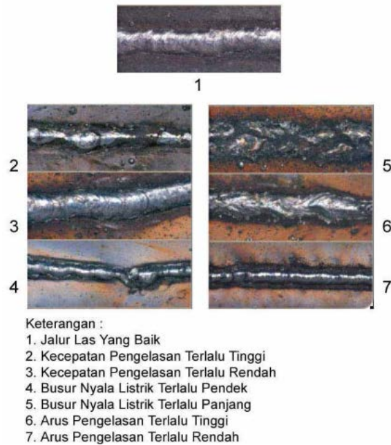
Gambar 4. Pengaruh kecepatan arus pengelasan terhadap hasil lasan
