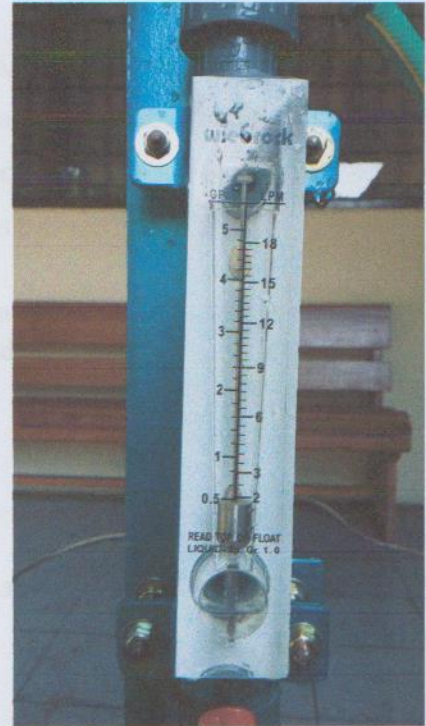
Gambar 4.13. Alat Ukur Debit Air Merk: Wiebrock, Kemampuan ukur maksimum 18 L/menit
