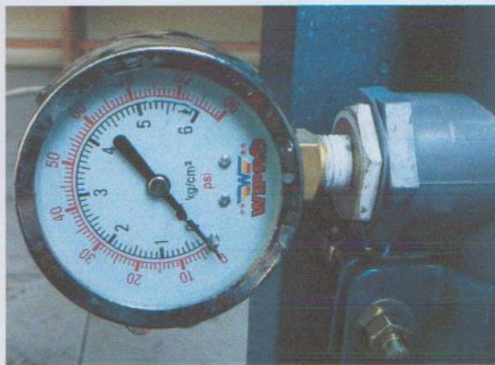
Gambar 4.14. Alat Ukur Tekanan Air Merk: Wipro, Kemampuan ukur maksimum : 6 kg/cm 2 (90 psi)
