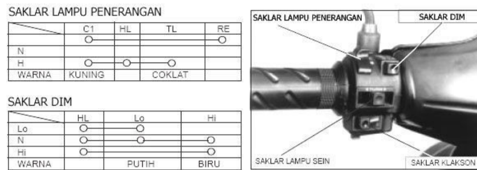
Gambar 19. Pemeriksaan Saklar Lampu Penerangan dan Saklar Dim
