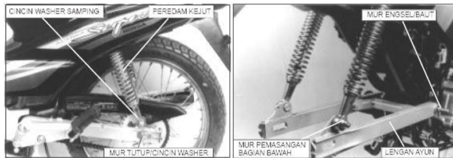
Gambar 64. Langkah Pelepasan Lengan Ayun (d) dan (e)
