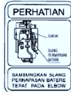
Gambar 14. Memeriksa Pipa Ventilasi Baterai
