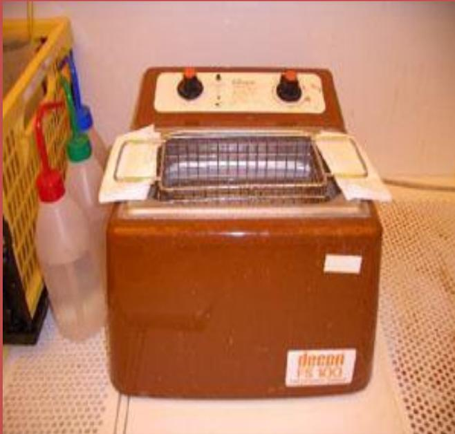
Ultrasonic bath dapat digunakan untuk menghilangkan gas (degassing) dan membersihkan kotoran yang menempel pada suatu wadah
