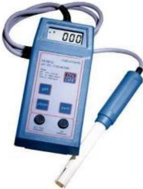
Digunakan untuk mengukur konsentrasi  $H^+$  di dalam larutan perlu dilakukan kalibrasi sebelum mengukur sampel
