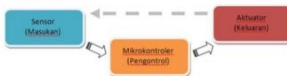
Gbr 1.Hubungan Sensor, Aktuator dan Mikrokontroler pada Robot
