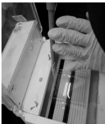
Gambar 2. Sampel dimasukkan ke dalam sumur yang terdapat gel, alat sipa dipasang dan disambungkan ke sumber listrik
