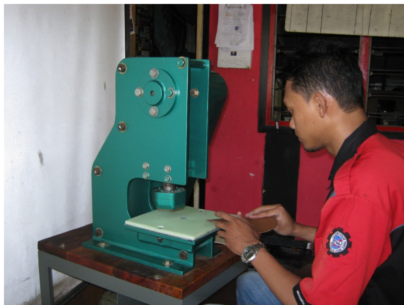
Foto 2. Uji Kinerja Mesin Pencetak Kulit Bola
