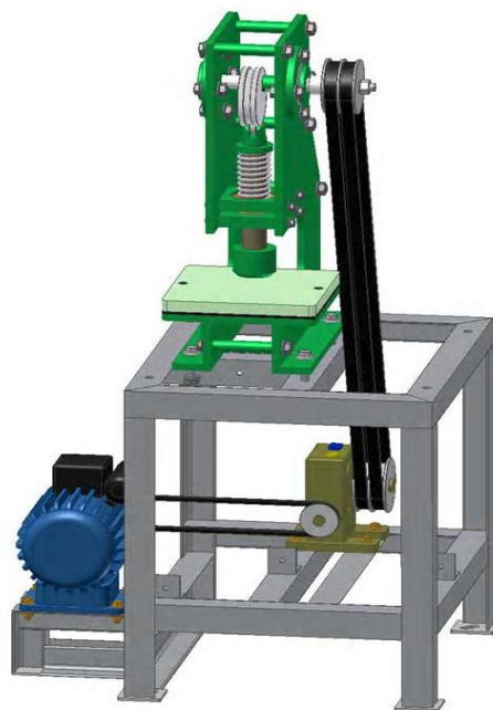
Gambar 20. Konstruksi rangka mesin dan beban yang bekerja
