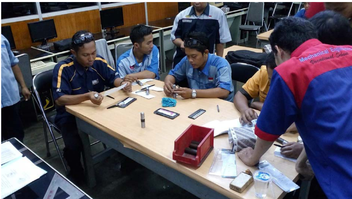
Peserta Pelatihan Secara Bergantian Melakukan Pemeriksaan/Pengukuran Kekasaran Permukaan Benda Kerja Hasil Pembubutan
