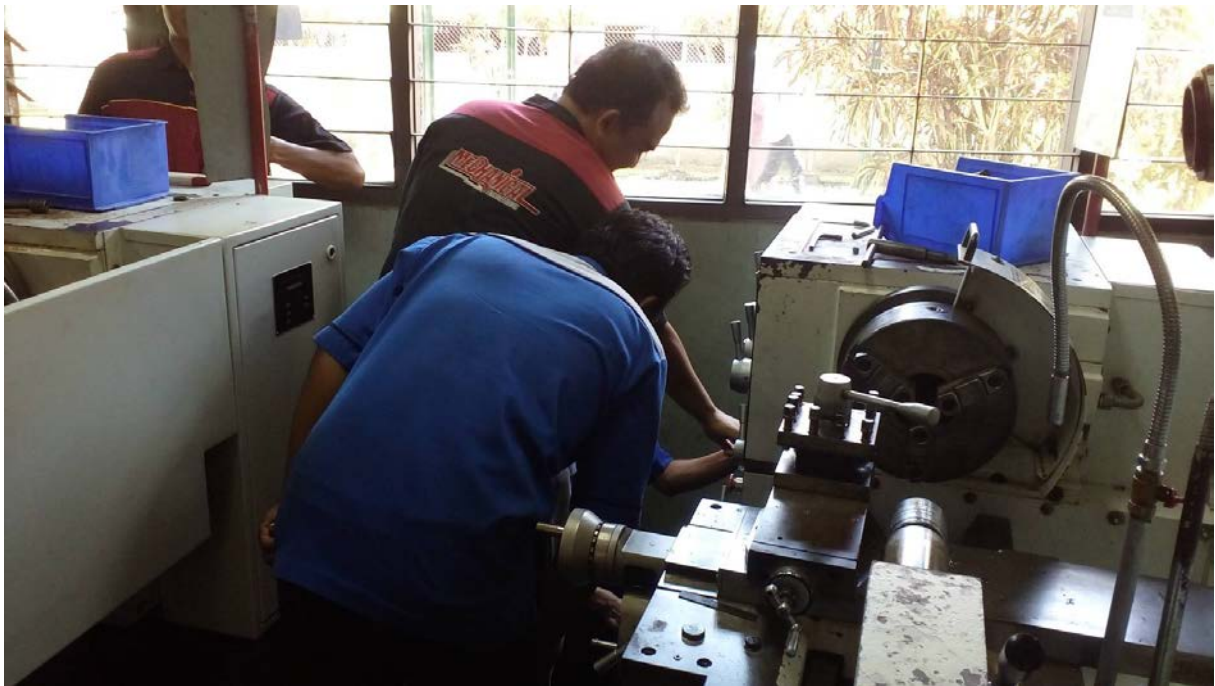
Peserta Melakukan Setting Mesin Sebelum Memulai Praktik Membubut Benda Kerja
