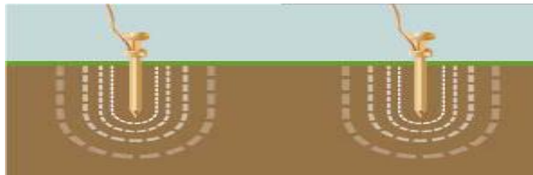
Gambar. Elektroda yang mempunyai pengaruh lapisan
