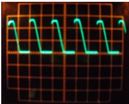
(a) (b) Gambar 18. Tegangan beban hasil pengendalian daya pada sudut picu 90^\circ (a), oleh modul sistem hasil penelitian, (b) oleh modul TCA 785
