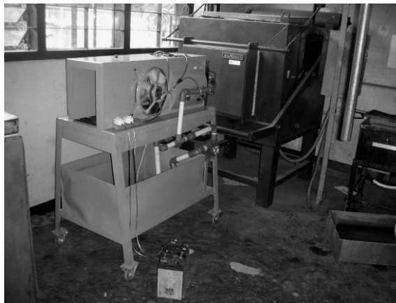
Gambar 6. Cooling chamber di depan dapur pemanas.
