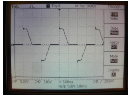
(a) (b) Gambar 8. Tegangan beban hasil pengendalian daya pada sudut picu 90^\circ (a), oleh modul sistem hasil penelitian, (b) oleh modul TCA 785
