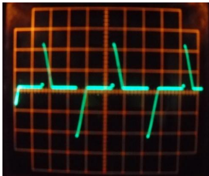
(a) (b) sudut Gambar 9. Tegangan beban hasil pengendalian daya melalui Triac pada sudut picu 135^\circ (a), oleh modul sistem hasil penelitian, (b) oleh modul TCA 785
