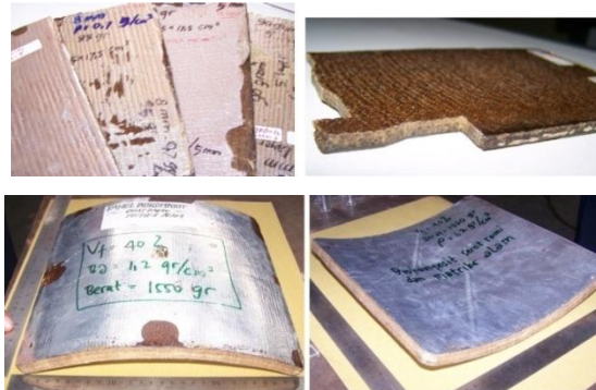
Gambar 10. Biokomposit dari matriks Matlac dengan reinforcement serat rami
