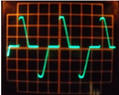
(a) (b) Gambar 8. Tegangan beban hasil pengendalian daya pada sudut picu 90^\circ (a), oleh modul sistem hasil penelitian, (b) oleh modul TCA 785
