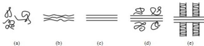
Gambar 23. diagram skematik ekstrusi arah
