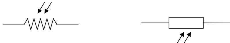
Aplikasi dari fotoresistor ini banyak diterapkan pada lampu penerang jalan dan pada control lampu parkir atau lampu taman Pada bidang Otomotif juga digunakan untuk control sistem pengapian elektronik serta untuk mengontrol lampu penerangan.
