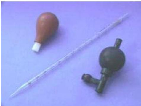
menuangkan cairan ke dalam pipet – cairan harus disedot masuk ke dalam pipet. Gambar di samping menunjukkan dua tipe pipet dengan balon. Pipet dengan balon merah merupakan pipet standar, sedangkan pipet dengan balon hitam merupakan pipet dengan **safety**. Meskipun tampak sederhana, pipet cukup mahal sehingga guru SMP perlu
